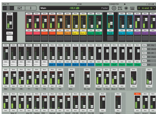
Jeden z owych 10 iPadów może służyć np. do permanentnego podglądu wskaźników poziomów wszystkich sygnałów w stole.
