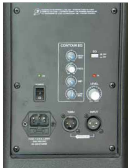
Nietypowym, acz niezwykle przydatnym elementem wyposażenia zestawu aktywnego jest korektor z przestrajającym pasmem środkowym.
