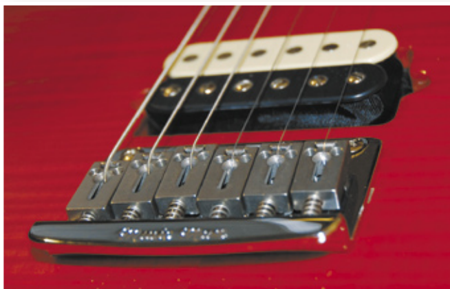
Drgania każdej ze strun przekazywane są osobno do przetworników piezoelektrycznych, umieszczonych bezpośrednio w siodełkach.
