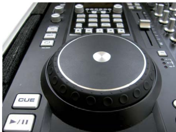
Prócz standardowego zastosowania jako przyspieszacz i zwalniacz utworu oraz scratch, JOG reaguje na dotyk – ma to na celu emulację zachowania prawdziwej płyty winylowej.
